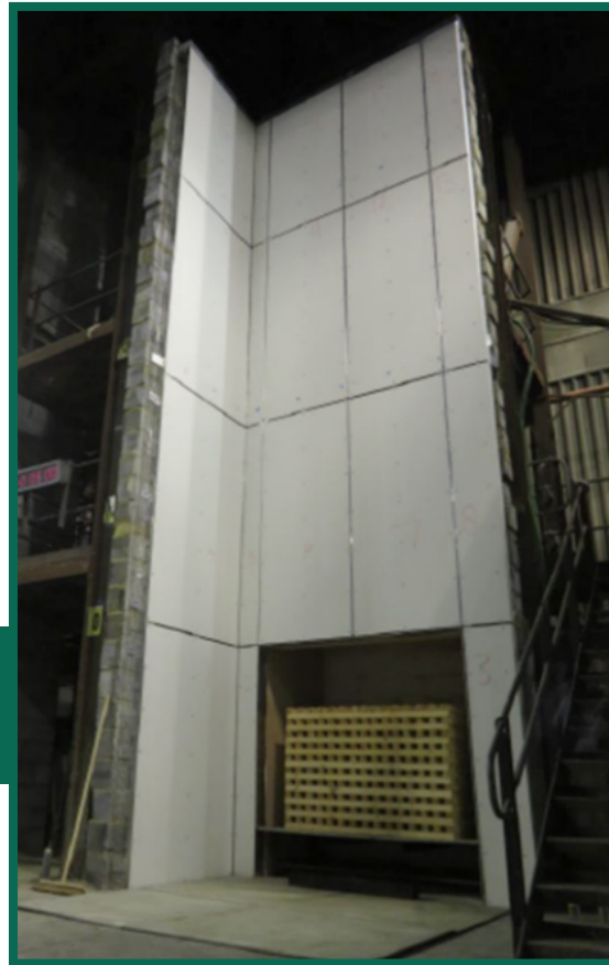
Figura 8. Sistema de fachada antes de ser sometida al ensayo a gran escala BS 8414.
