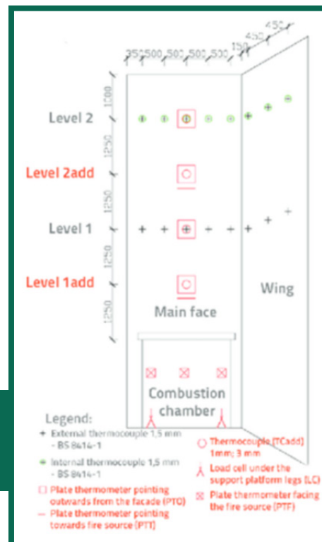
Figura 9. Esquema de niveles y posición de termopares del ensayo a gran escala BS 8414.
