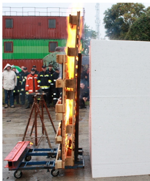
Imagen: Quema del pallet de madera enfrente del bloque para construcción de EPS
