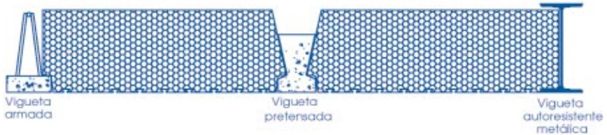
La pieza de entrevigado que forma parte de la sección del forjado, además de aligerar, moldea la sección resistente. Para ello debe de cumplir unas condiciones geométricas mínimas, especialmente en forjados semiprefabricados, para garantizar la unión entre los elementos resistentes prefabricados y el hormigón vertido in-situ (ver apartado de diseño y dimensionado de este manual).
