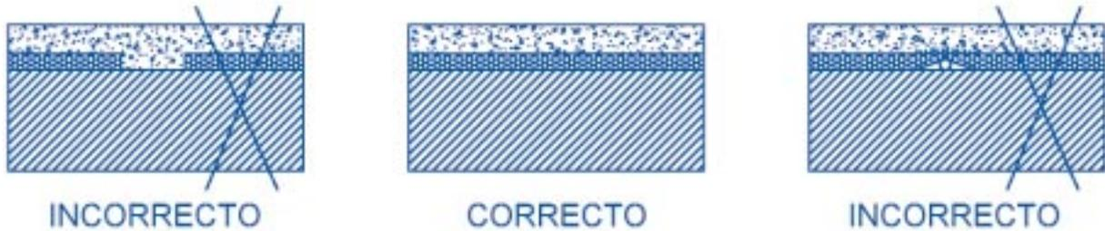
b) La unión con paredes o pilares, tanto de la losa como del pavimento final, se ha de aislar de la misma manera.
